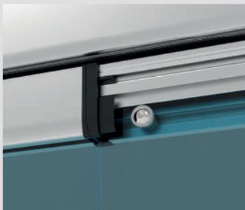
Vollständige Garantie für die Befestigung des Glases am Flügelprofil mittels Schrauben, wodurch ein perfekter und dauerhafter Betrieb gewährleistet wird. Das System wird durch die Verwendung eines klebenden Polymers als zusätzliche Sicherheitsmaßnahme ergänzt.
