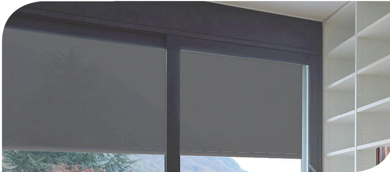
El toldo tipo screen **Habitat ZIP** de **C3 Systems** consiste en un sistema enrollable con cofre que incorpora una cremallera soldada en los laterales del tejido, además de un sistema de muelles en las guías laterales, aportando una tensión mayor que en los sistemas convencionales, y que permite abarcar superficies de grandes dimensiones.
